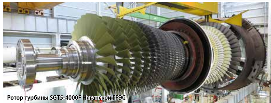
Окончательная проточка турбинных лопаток перед монтажом
